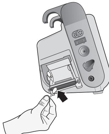
**Abbildung 17-3. Reinigen des Druckkopfs**
