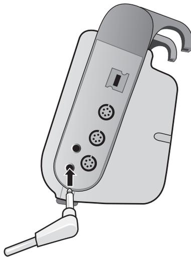
**Abbildung 12-1 Anschließen der Temperatursonde an das Propaq M Gerät**
