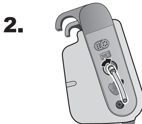
**Abbildung 8-2 Anbringen eines einlumigen Schlauchs am Propaq M Gerät**
